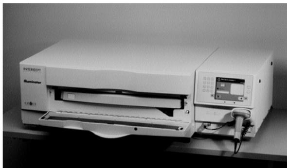
Из внутренней части облучателя выдвигается выдвижная панель. В выдвижной панели установлен прозрачный поддон, в котором происходит облучение. Выдвижная панель расположена на перемешивателе планшетного типа, таким образом препараты крови перемешиваются, находясь в облучателе. В поддоне имеются четыре отделения для хранения во время облучения препаратов крови и прилагаемых наборов для обработки препаратов крови.
