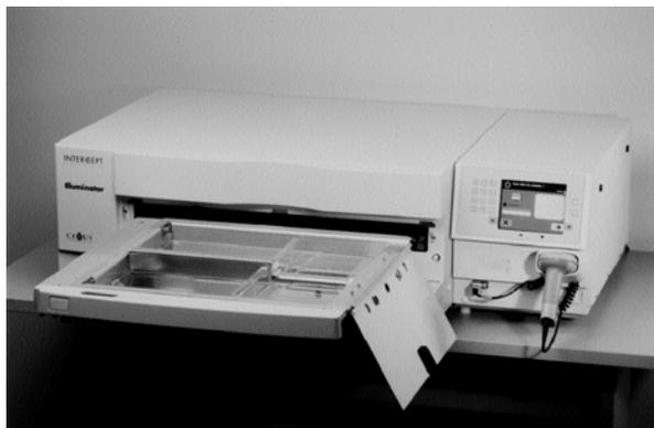
Один препарат крови и набор для обработки устанавливают в переднюю камеру, камеру 1. Препарат крови в контейнере для облучения помещается в левой части камеры, при этом остальная часть набора помещается в правой части камеры.
