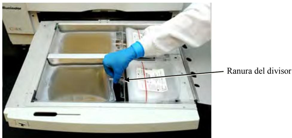
11. Coloque los otros envases en el lado derecho de la cámara 1 frontal de manera que la etiqueta del envase de almacenamiento se encuentre mirando hacia arriba.
