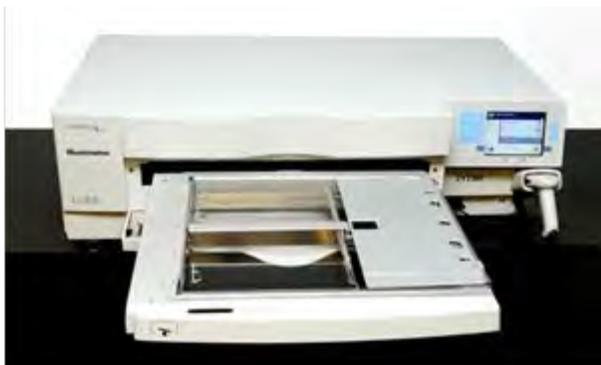
7. Abra la cubierta de la bandeja deslizando el cierre negro hacia la derecha. (La cubierta se abrirá hacia la derecha.)
