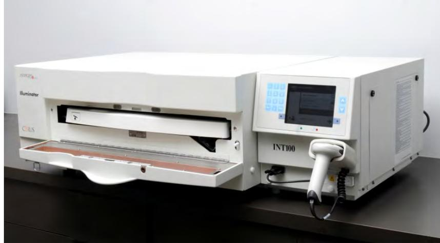
En el interior hay un cajón que se extrae tirando de él. En el cajón existe una bandeja transparente donde se realiza la iluminación. El cajón está en un agitador plano de manera que los productos se agitan cuando se encuentran en el iluminador. Existen cuatro compartimentos en la bandeja que almacenan hemoderivados y los equipos de procesamiento correspondientes, durante la iluminación.
