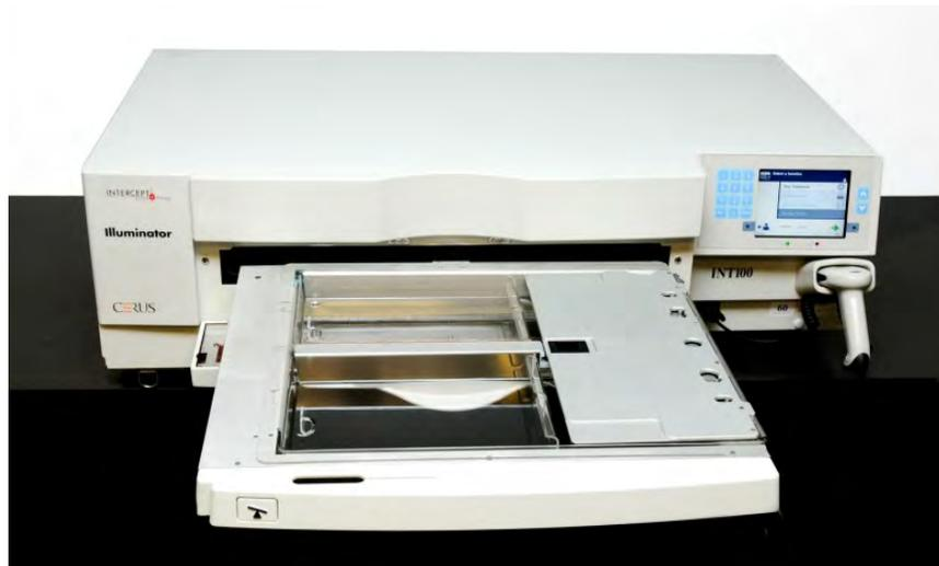
Existe una cubierta para los dos compartimentos en el lado derecho, diseñada para evitar que el equipo y los tubos queden atrapados durante la agitación. El operador abre esta cubierta para cargar el equipo y la cierra antes de comenzar la iluminación.
