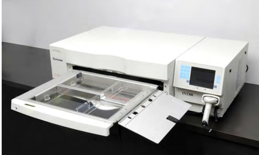
En la cámara frontal, la 1, se instala un hemoderivado y un equipo de procesamiento. El hemoderivado del envase de iluminación va en el lado izquierdo de la cámara, y el resto del equipo se sitúa en el lado derecho de la cámara.
