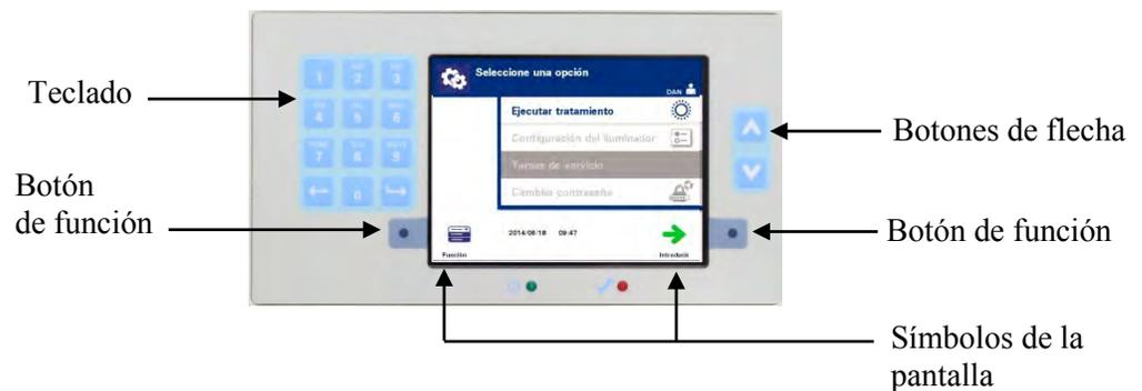
Los botones de función tienen etiquetas y símbolos de pantalla que cambian según el paso para facilitarle el desplazamiento por las pantallas.
