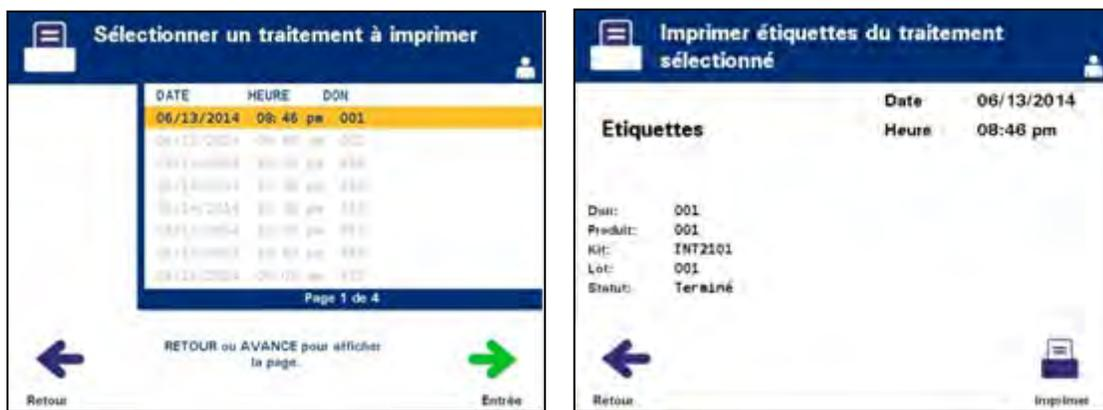
5. Sélectionnez le traitement souhaité à l'aide des touches fléchées. Si le traitement ne figure pas à l'écran, appuyer sur la touche Avance (→) ou Retour (←) du clavier pour afficher les pages suivantes de traitements. Continuez à utiliser ces touches jusqu'à trouver la page comportant le traitement souhaité. Ensuite, utilisez les touches fléchées pour choisir le traitement.
